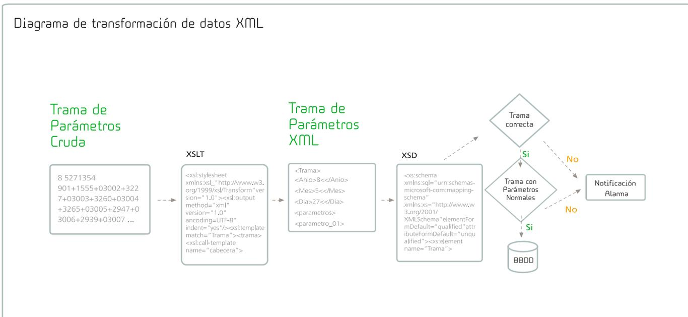
Esta solución posibilita, por un lado, la captura y almacenamiento remoto o local de los distintos parámetros de funcionamiento de cada central nuclear y, por otro, la recepción y almacenamiento de los distintos parámetros físicos desde las distintas fuentes de origen sobre en un sistema central para su posterior transmisión hacia las diferentes aplicaciones de la SALEM o bien hacia los sistemas de otras instituciones.
